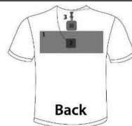
شکل ۱- نحوه قرار گرفتن حسگر اندازه‌گیری دما و فلاکس‌متر: ۱- پارچه سه لایه گرمازا، ۲- حسگر اندازه‌گیری دمای سطح پارچه، ۳- فلاکس‌متر
